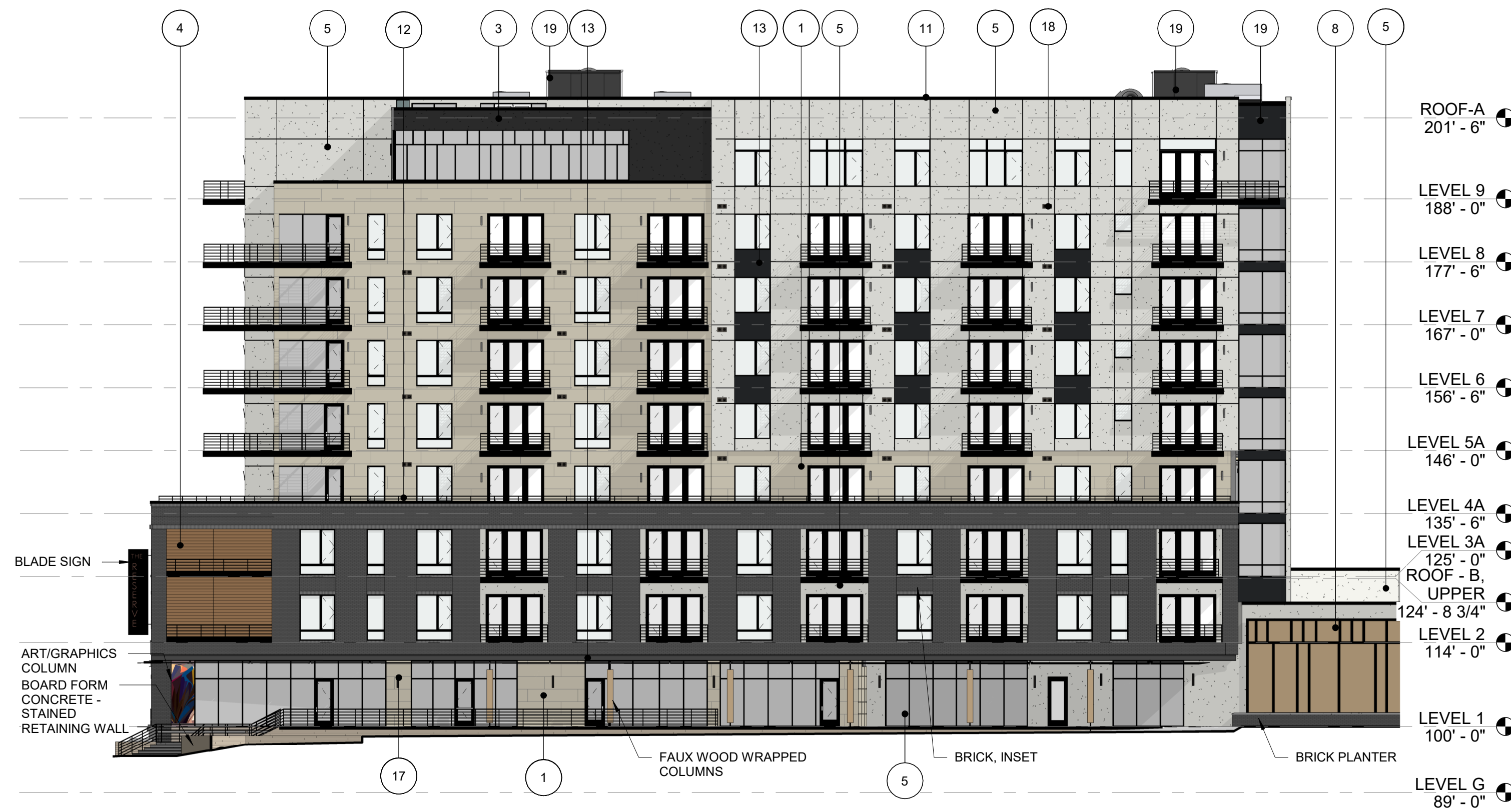
2 SIP WEST ELEVATION IL 1/16" = 1'-0"
